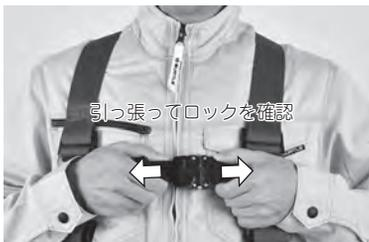
**!** ベルトがねじれていないこと(連結金具本体のロック確認窓から差込プレートの赤色が見えていること)を確認してください。
