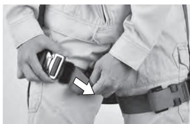
固定機能付ベルト通しのバーにベルトを掛けて、留めます。
