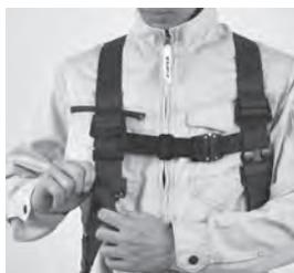
(5) 固定機能付ベルト通しのバーでベルトを留めます。余長部分が長い場合は折り返して、余長止め付ベルト通しで留めます。
