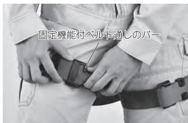
ベルトの余長部分が長い場合は、ベルトを折り返し、余長止め付ベルト通しで留めます。
